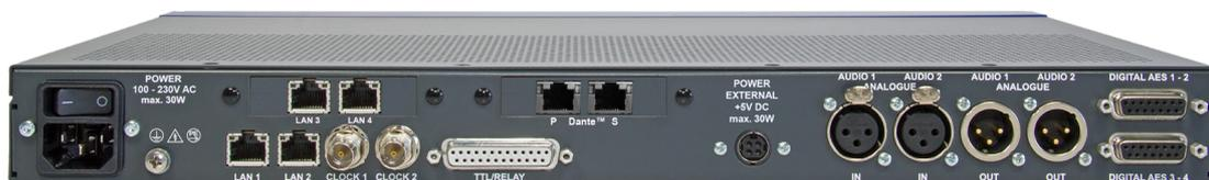
MAGIC THipPro mit VoIP, redundanter Stromversorgung, Dual LAN- und Dante-Modul
